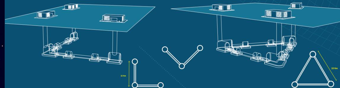
Rappresentazione schematica dell'infrastruttura sotterranea di ET e delle due possibili configurazioni, e la sua localizzazione in Sardegna
